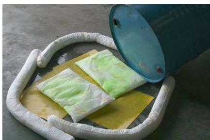
Unidad versátil de múltiples aplicaciones en la industria, transporte o servicios de emergencia. Es el medio más eficaz y económico para controlar y recoger derrames de líquidos. De fácil y rápida utilización, contiene una gama de absorbentes para ser colocados en las zonas donde exista potencial peligro de derrame.
